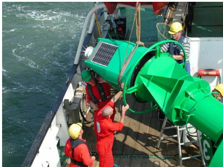
Abb. 2a: Montage eines SKA ohne Schnellkupplung an Bord eines Tonnenlegers
