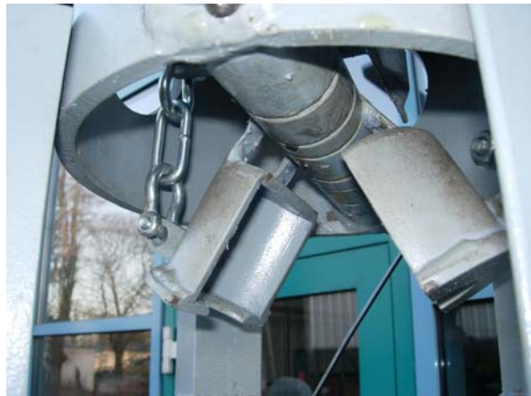
Abb. 20: Geöffnete Klauen der Schnellkupplung
