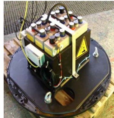
Abb. 13: Zusammengesetzte Einzelzellen im Batterieträger
