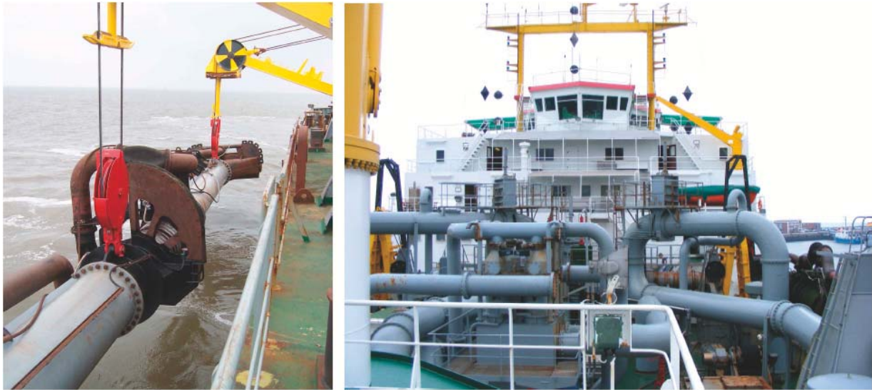
Abb. 3 und 4: Saugrohr und Rohrleitungen
